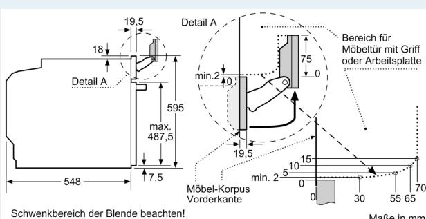
Wird das Gerät unter einem Kochfeld eingebaut, muss folgende Arbeitsplattenstärke (ggf. inkl. Unterkonstruktion) beachtet werden.
