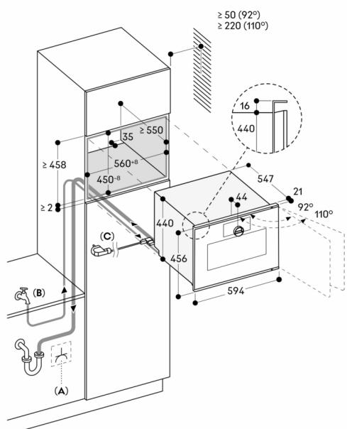
**A:** Frei zugänglicher elektrischer Anschluss
