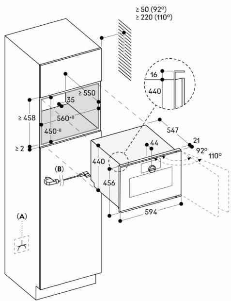
A: Frei zugänglicher elektrischer Anschluss
