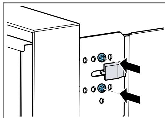
Je weiter rechts Sie die Schrauben am Gerät festschrauben, umso kleiner der Türöffnungswinkel. Bei der rechten Position der Schrauben beträgt der Öffnungswinkel der Gerätetur ca. 97°.
