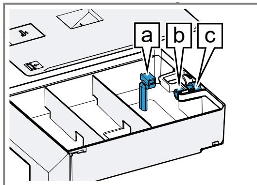
4. Prüfen, ob der Ansaugschlauch frei von Rückständen ist.
