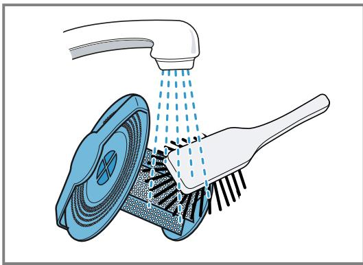
4. Das Ablaufsieb unter fließendem Wasser ausspülen oder bei starker Verschmutzung im Geschirrspüler reinigen.
