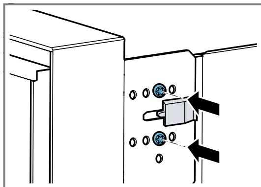
Je weiter rechts Sie die Schrauben am Gerät festschrauben, umso kleiner der Türöffnungswinkel.
