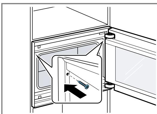
13. Die Transportsicherung aus rotem Kunststoff am oberen Türverschluss entfernen.
