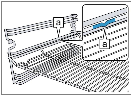
2. Sicherstellen, dass der Sicherheitsbügel des Rosts sich hinten befindet und nach oben zeigt.
