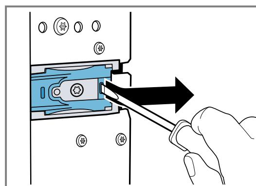
7. Wenn die Dicke der Möbelseitenteile 19 mm beträgt, die weißen Kunststoffelemente entfernen ①, um 180° drehen ② und wieder einsetzen ③.
