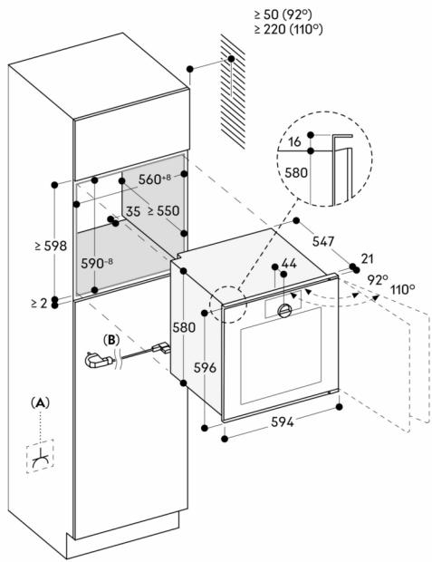
A: Frei zugänglicher elektrischer Anschluss
