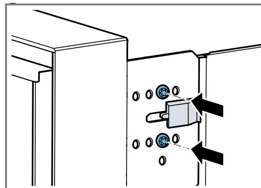
Je weiter rechts Sie die Schrauben am Gerät festschrauben, umso kleiner der Türöffnungswinkel. Bei der rechten Position der Schrauben beträgt der Öffnungswinkel der Gerätetür ca. 97°.
