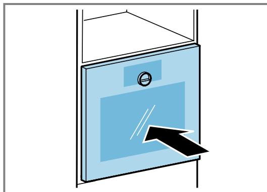
**9. Das Gerät mittig ausrichten.**
