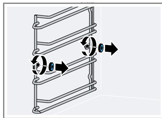
3. Die Einschubroste etwas seitlich von der Schraube wegziehen ① und nach vorn herausziehen ②.
