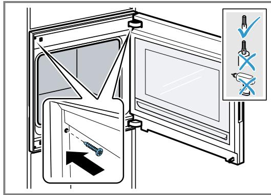
**13. Die Transportsicherung an der Tür entfernen.**
