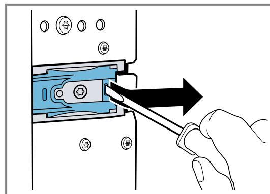
7. Wenn die Dicke der Möbelseitenteile 19 mm beträgt, die weißen Kunststoffelemente entfernen ①, um 180° drehen ② und wieder einsetzen ③.
