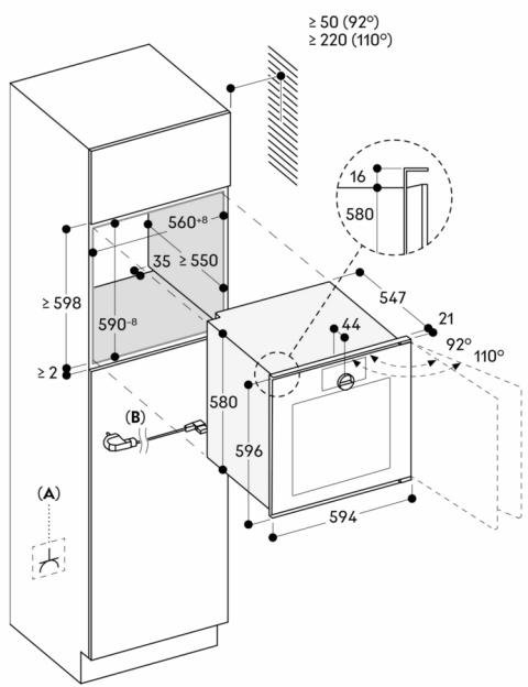
**A:** Frei zugänglicher elektrischer Anschluss
