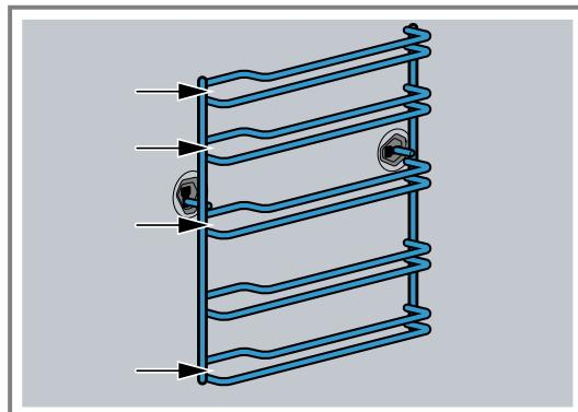
2. Den Einschubrost zuerst in die hintere Buchse einstecken ① und etwas nach hinten drücken ②.
