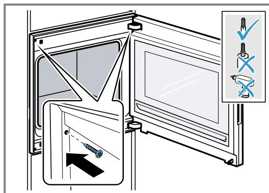
13. Die Transportsicherung an der Tür entfernen.
