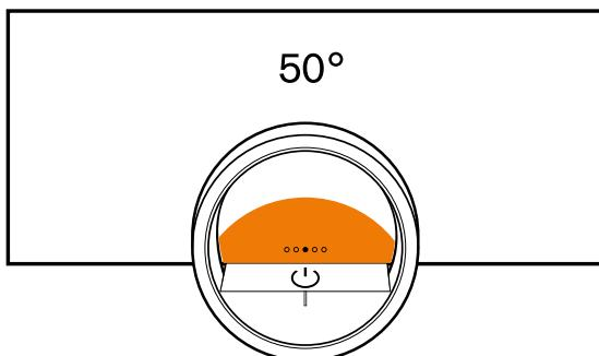
Der Ausschnitt des Kreises in Orange wird umso größer, je länger der Timer läuft.
