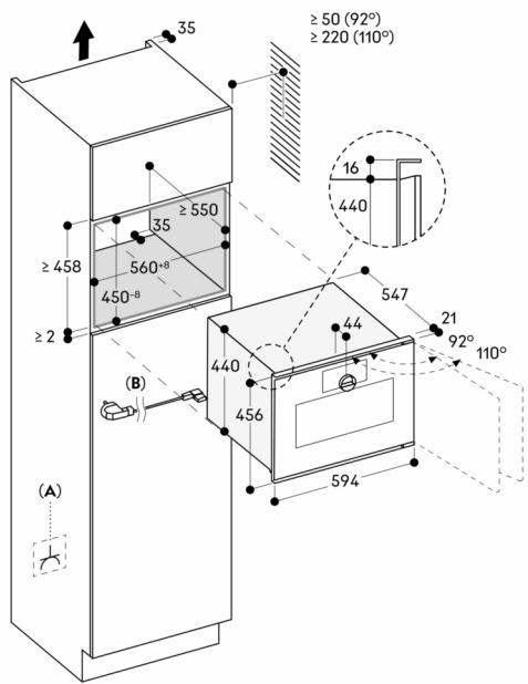
A: Frei zugänglicher elektrischer Anschluss
