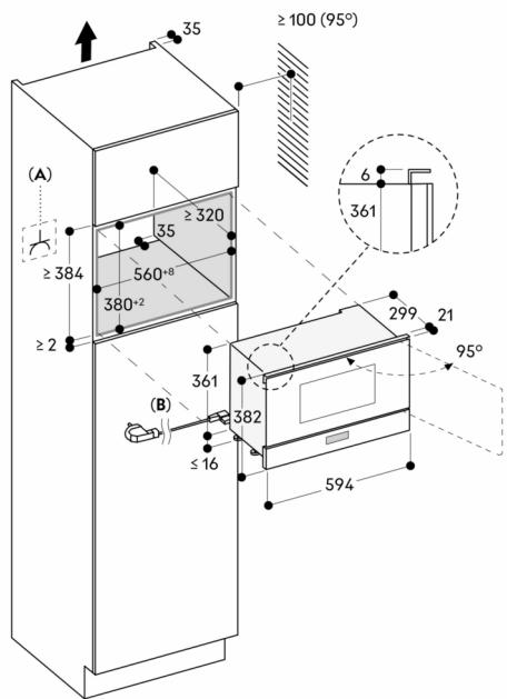
**A:** Frei zugänglicher elektrischer Anschluss
