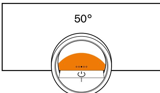
Der Ausschnitt des Kreises in Orange wird umso größer, je länger der Timer läuft oder je mehr sich die Kerntemperatur des Garguts der eingestellten Kerntemperatur nähert.
