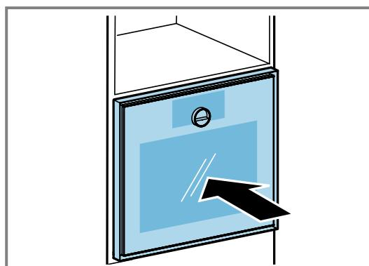
**9.** Das Gerät mittig ausrichten.
