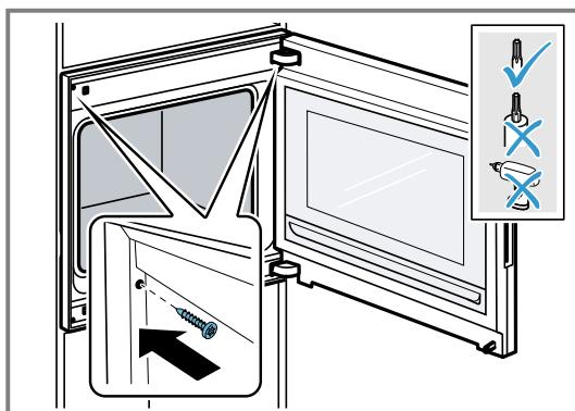
**13.** Die Transportsicherung an der Tür entfernen.
