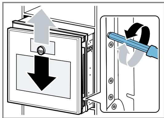
5. Die zwei Schrauben an der Geräteseite festschrauben.
