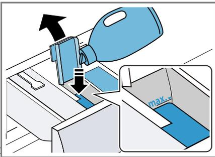
Überschreiten Sie beim Füllen nicht die Markierung des Maximalfüllstands.
