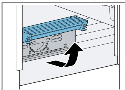
2. Die Bypass-Kappe um 90° gegen den Uhrzeigersinn drehen ① und entnehmen ②.
