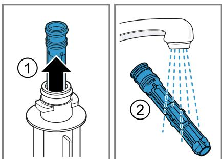
3. Das Sieb wieder in die Bypass-Kappe einsetzen.
